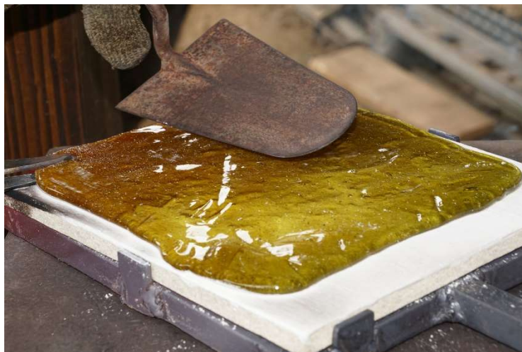
Formen des Fensterglases mit Pinzette und Maurerkelle (M-DSC09842.jpg ©2024 Manuela Arz)
